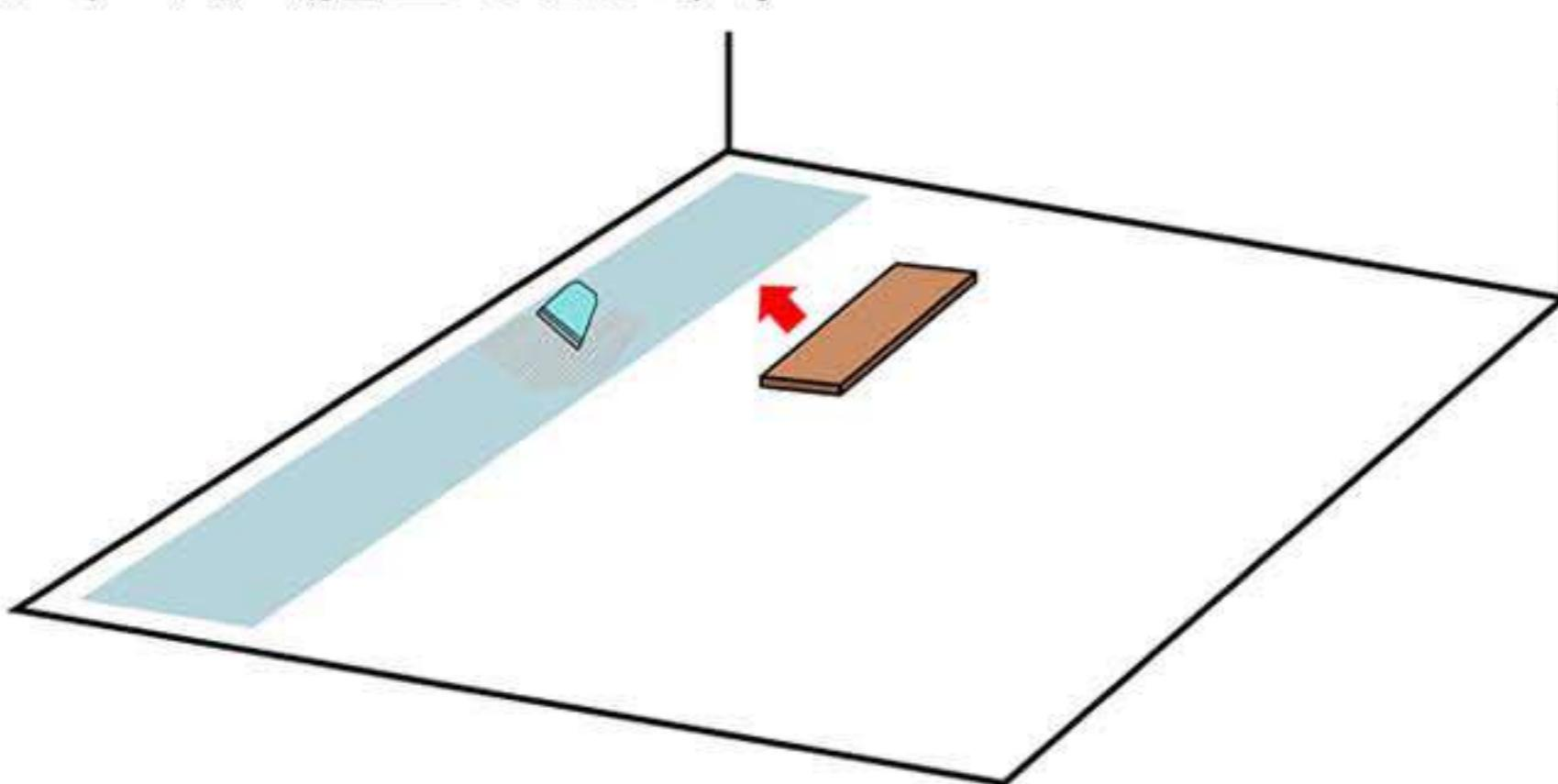
接着材が床にこぼれたり、手足につかないように絶えずチェックしながら作業して下さい。フローリング用の接着材は非常に強力で乾くと取れなくなり、仕上がりが汚くなります。こぼれたらボンドふきたろうすぐに拭き取って下さい。（水拭きでは接着材は取れません）
